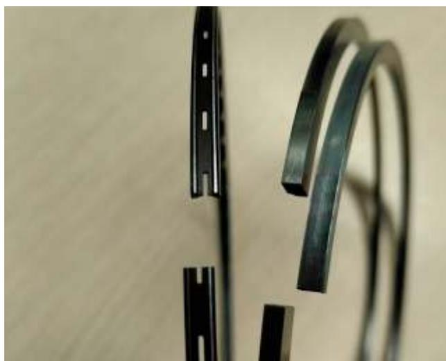
В отличие от чугунного маслосъемного кольца, которое изготавливается посредством механической обработки отливки, стальное маслосъемное кольцо навивается из стальной ленты. Данная лента в сечении имеет профиль готового кольца, и в ней уже прорезаны маслоотводящие окна.
