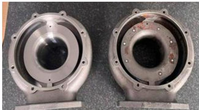
Оба изготовлены из материала QT450-10 (высокопрочный чугун).
