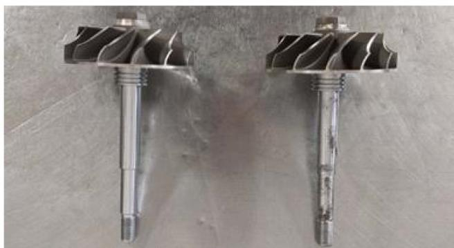
В производстве турбокомпрессоров ТМ «Мотордеталь» используется новый сплав K418 (INCO 713C) с содержанием никеля свыше 77%. У аналога стандартный сплав с содержанием никеля 55...60%. Структура материала неоднородна, что является признаком изготовления детали из вторичного сырья.
