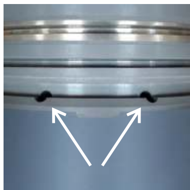
Фото 1 Отверстия в кольцевой канавке
